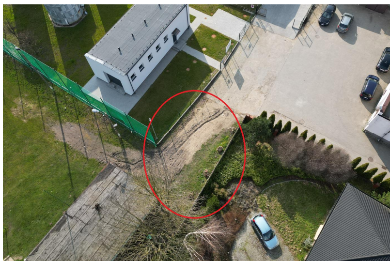
Obszar wykonania nawierzchni z kostki betonowej gr. 8 cm wraz z odwodnieniem
